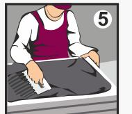
Для оснований с неровностями до 3 мм на 2 м стены: Нанесите клей зубатым шпателем на горизонтально уложенную плиту утеплителя по всей площи, с отступом 3-4 см от края слоем 2-3 мм.
