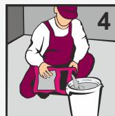
Для подготовки смеси возьмите чистую водопроводную воду комнатной температуры из расчета 5,0 - 6,0 л воды на 1 мешок (25кг) и залейте её в чистую ёмкость.
