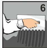
Нанесите клей зубчатым шпателем. Размер зубьев зависит от размера и веса укладываемой плитки. При укладке крупноформатных, тяжеловесных плит нанесите тонкий слой клея на тыльную поверхность плитки, что улучшит контакт поверхности плитки с kleem. В этом случае расход клея увеличится. Уложите плитку в течение 30 минут после нанесения клея. Выровняйте плитку в течение 20 минут.
